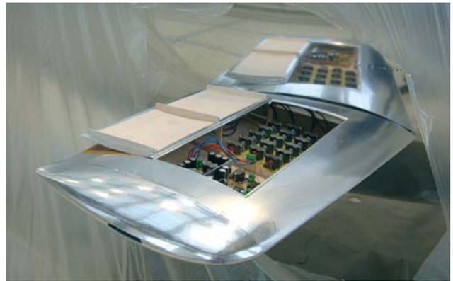
BILD 10. *b-IONIC Airfish* Flügel mit Generator/Batterien.
