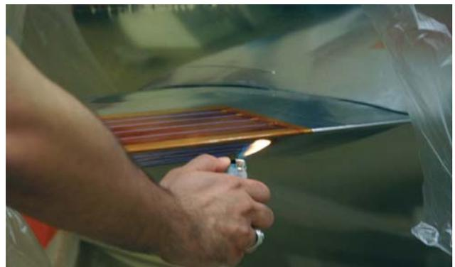
BILD 3. Plasmawellenantrieb an den Stummelflügeln.
