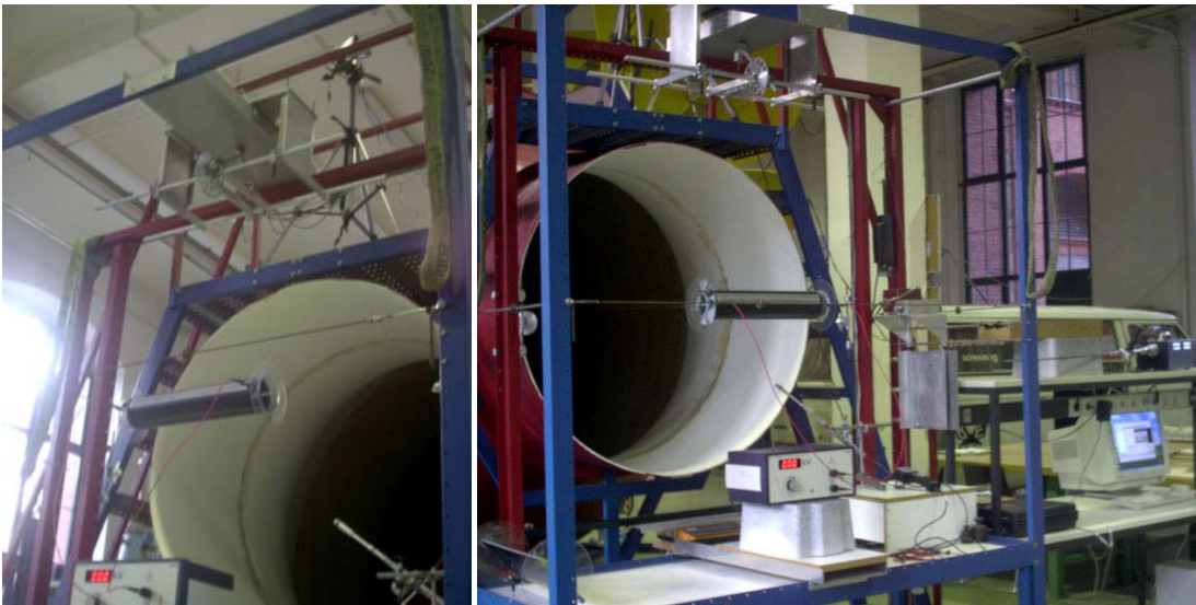
Bild 1 und 2: Versuchsaufbau am großen Freistrahwindkanal des Instituts für Bionik, TU Berlin.
